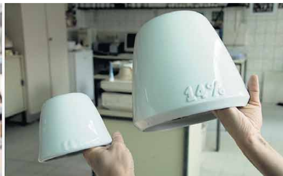
Zur Lampe „14%“ wurde die Weimarer Designerin Laura Straßer (31) durch eine Eigenschaft des Porzellans inspiriert: Es schrumpft beim Brand etwa um 14 Prozent. Jeder Schirm ist Abguss des größeren Schirms und Vorlage für den kleineren.
